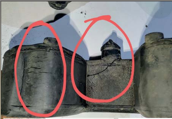
Auch Ruckdämpfer verschleißen
